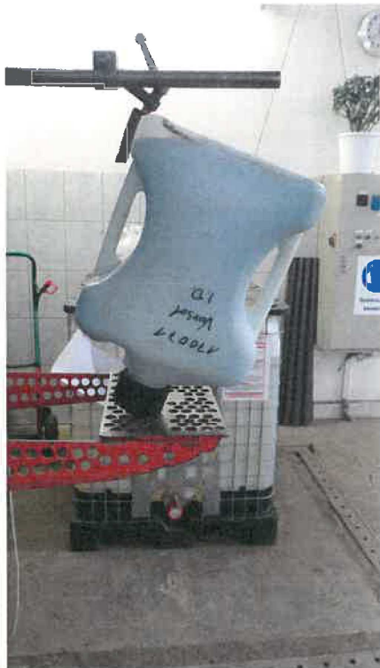
Bild 2: Fallversuch auf den Verschluss
