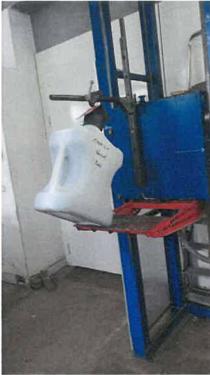
Bild 4: Fallversuch diagonal auf den Unterboden
