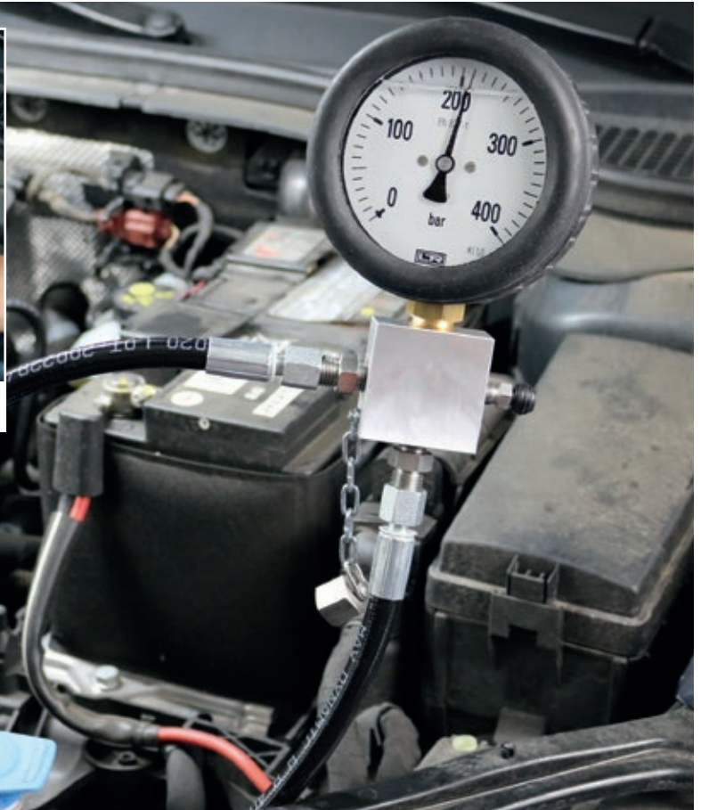
Dynamische Prüfung mit digitalem Manometer, bei laufendem Motor.
