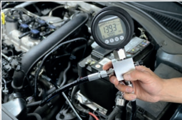
Dynamische Prüfung mit digitalem Manometer, bei laufendem Motor.
